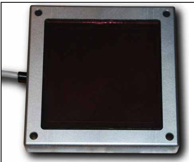
Abb. 9: Sensor eines für die Lichtmessungen verwendeten Lightmeters. Die Sensorfläche beträgt rund 50\text{ cm}^2 , woraus sich die hohe Lichtempfindlichkeit dieses Geräts ableitet.
