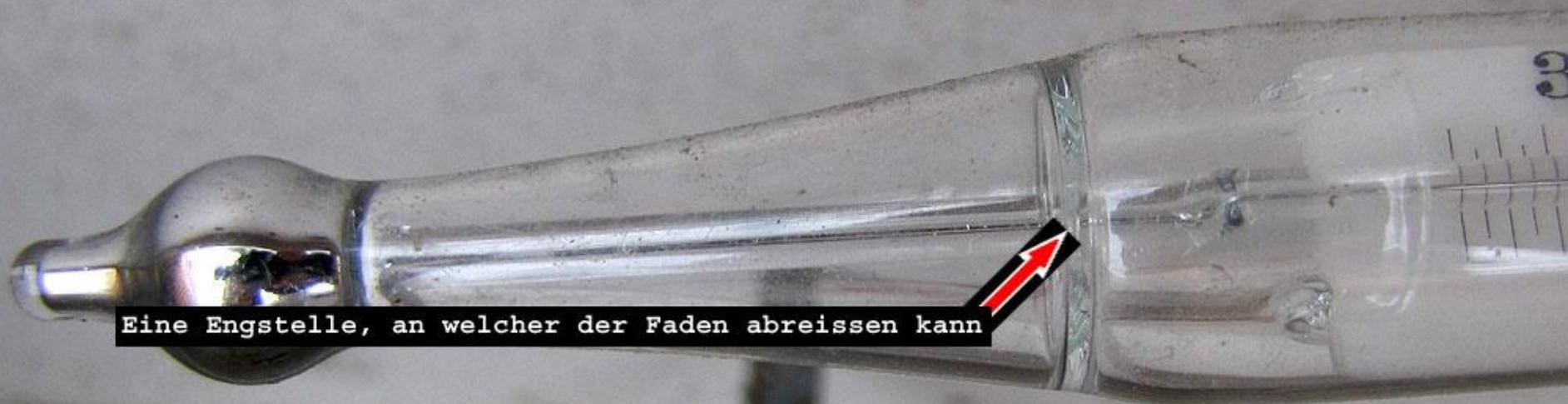
Eine Engstelle, an welcher der Faden abreißen kann
