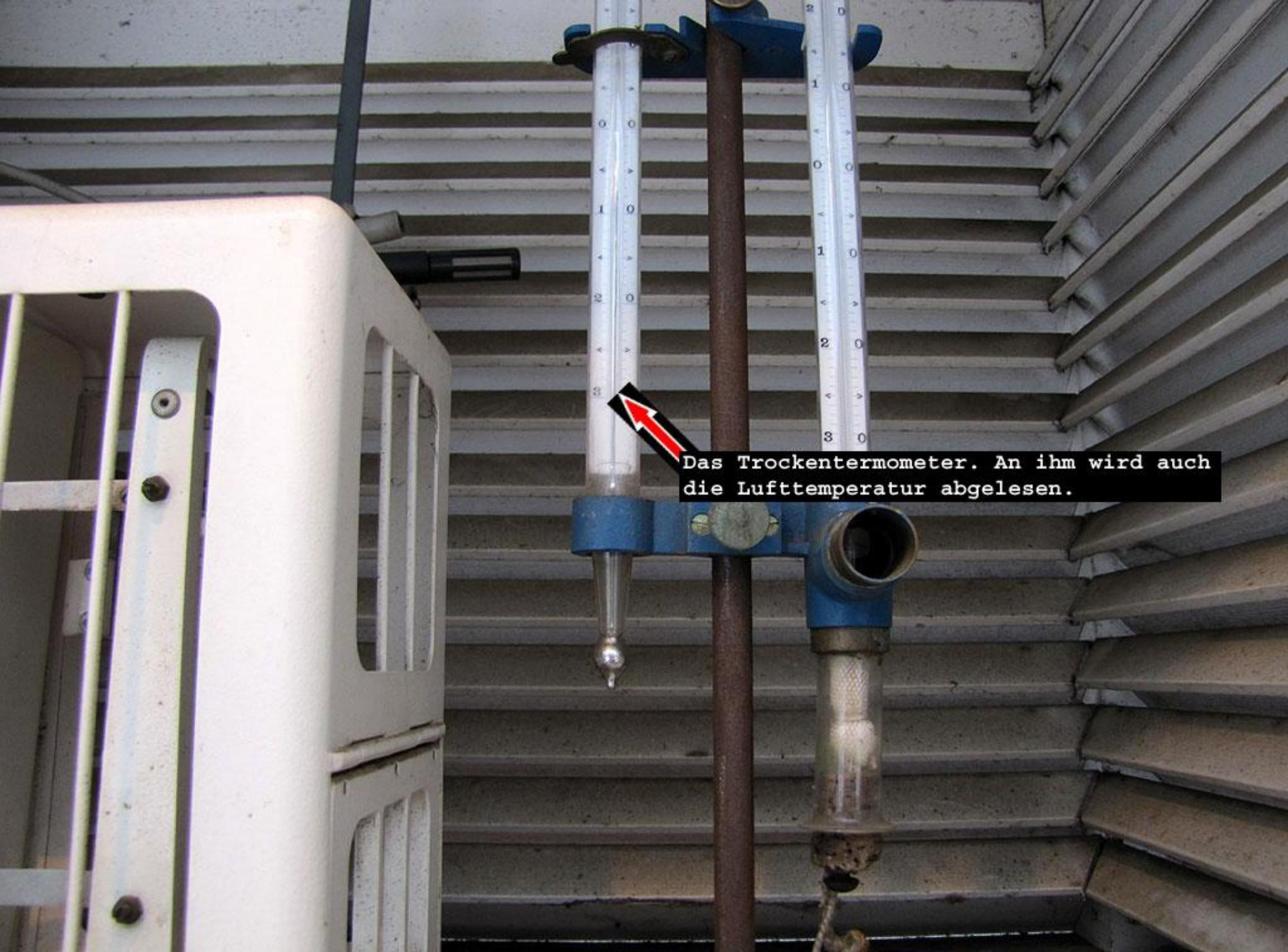
Das Trockenthermometer. An ihm wird auch die Lufttemperatur abgelesen.
