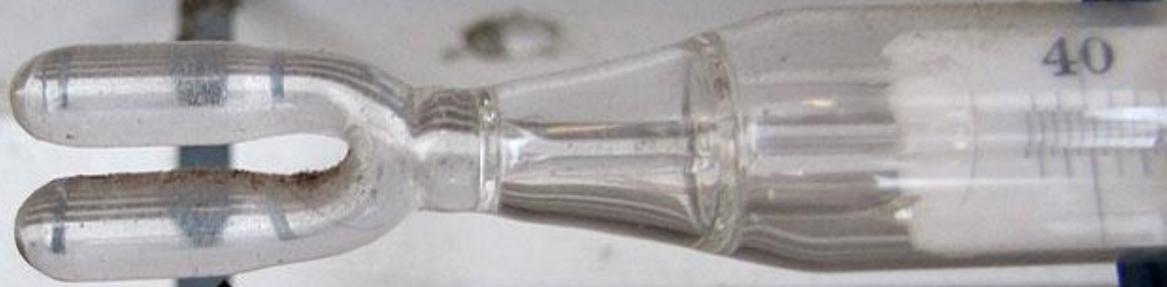
U-förmiges Vorratsgefäß - größere Oberfläche
